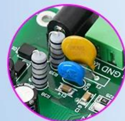
电源接口 防静电、防涌浪、防短接
